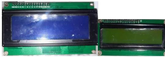
Gambar 5 LCD I2C, (a). 20x4, (b). 16x2
