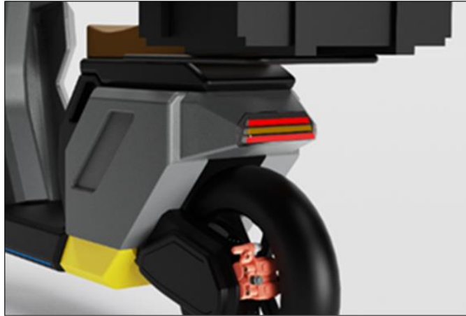
Gambar 2. Pemodelan 3D dari desain lampu belakang objek penelitian
